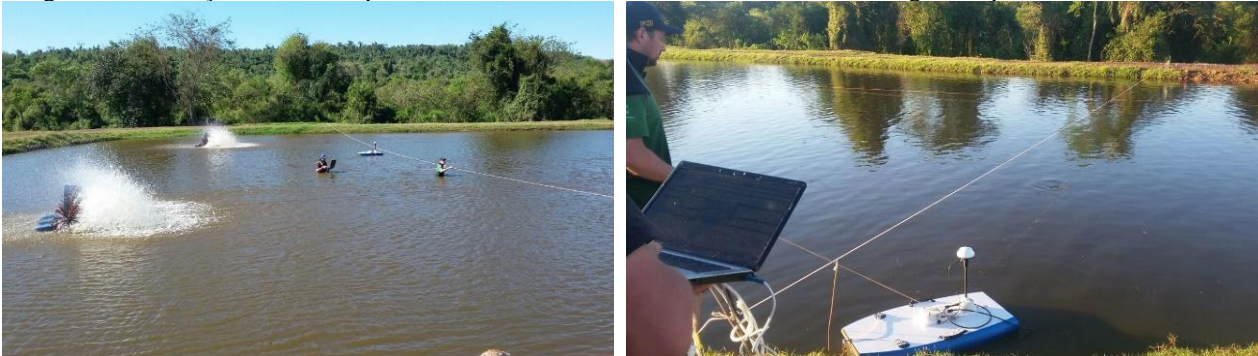
Figura 2. Utilização do ADCP, para determinar a velocidade de deslocamento da água e a profundidade do viveiro
