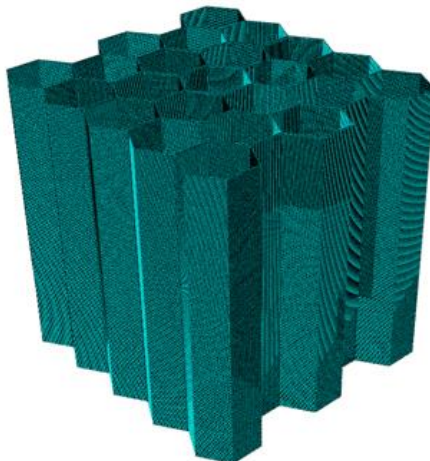
Figura 5 - Malha de elementos finitos do núcleo honeycomb .
