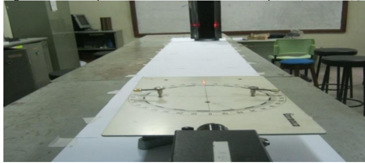
Figura2 – Teste Óptico do Coletor Parabólico Composto (45° e 45°)[4]
