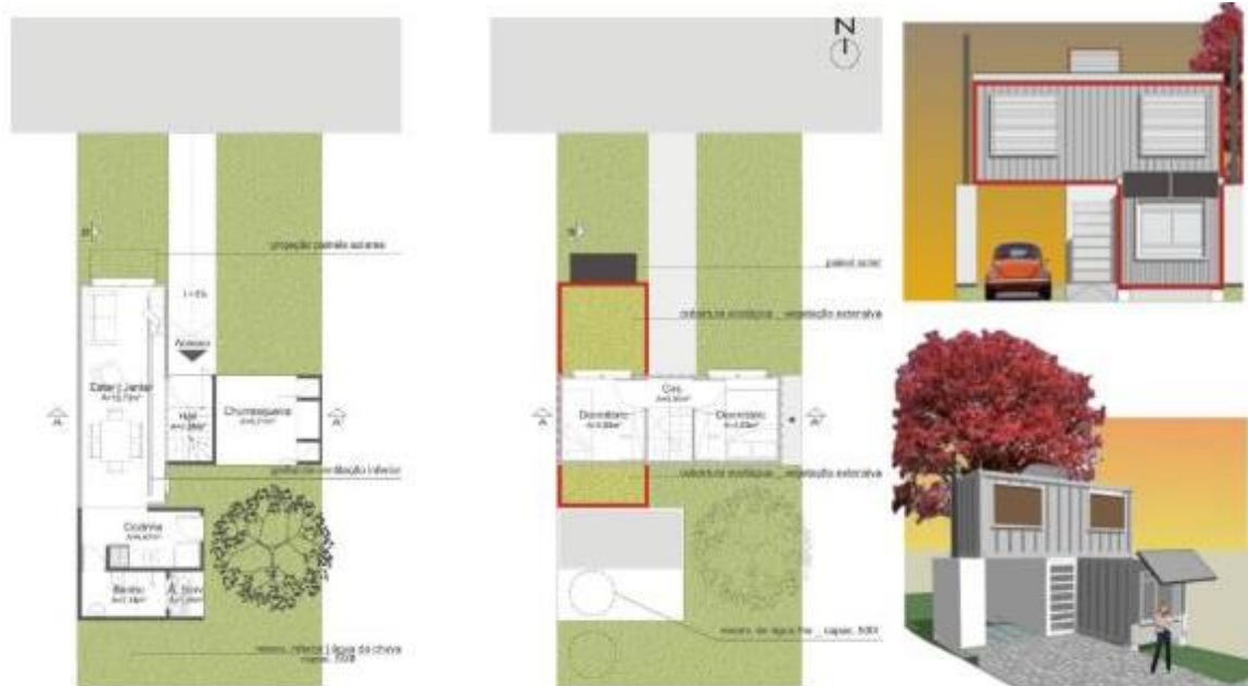
Figura 10 – Fachada Norte, perspectiva e plantas baixas da proposta de HIS em container
