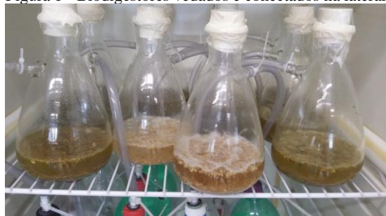
Figura 1 - Biodigestores vedados e conectados na lateral.
