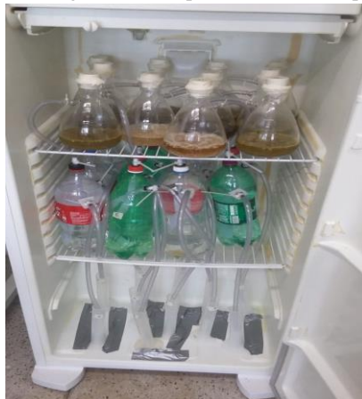
Figura 2 - Biodigestores, gasômetros e provetas montados para o experimento.
