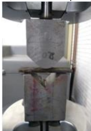
Figura 6 – Ferramental utilizado para o dobramento.
