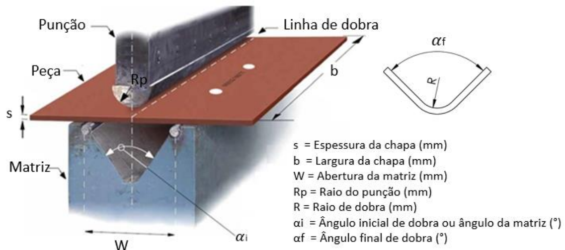
Figura 1 – Processo de dobramento de uma chapa [4].
