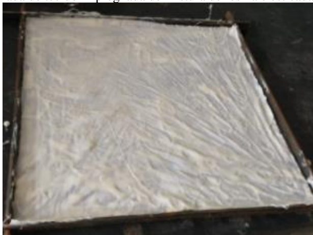
Figura 2: Primeira camada de tecido impregnada de mistura de resina e esticada sobre a chapa de metal.
