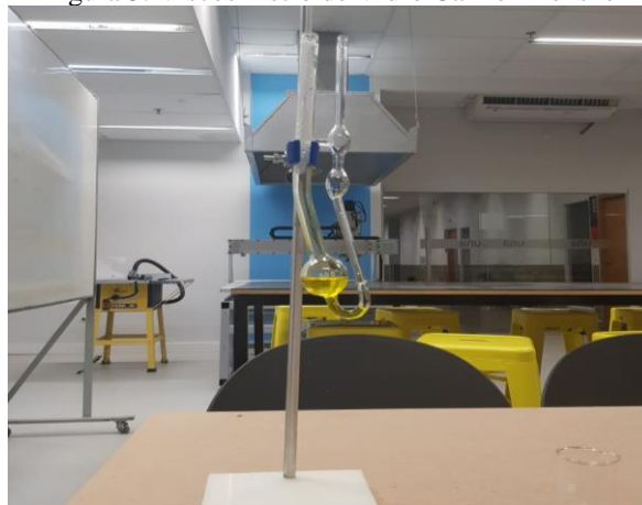
Figura 3. Viscosímetro de Vidro Cannon-Fenske
