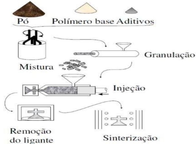
Figura 1. Fluxograma do processo de MPI [7].
