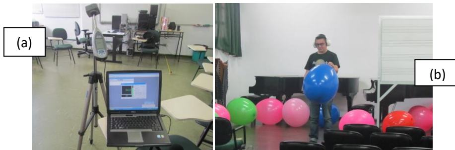
Figura 1. Montagem dos equipamentos de medição acústica (a); geração do impulso - estouro de balão (b)
