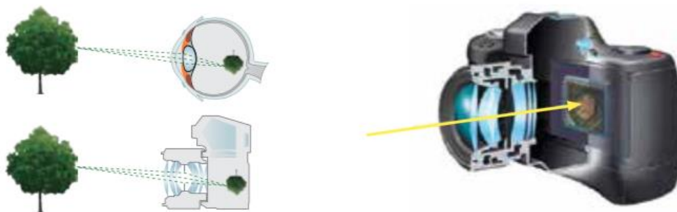
Imagem 1: À esquerda, são esquematizadas as imagens sendo formadas no olho e em uma câmera fotográfica; à direita, é apresentada a localização do sensor, mostrado através de um corte na câmera (Gomide 2014)
